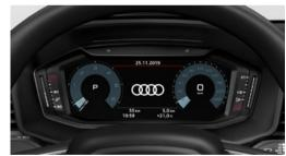
Mit dem Audi virtual cockpit steht ein volldigitales Kombiinstrument zur flexiblen und bedarfsgerechten Anzeige von Informationen zur Verfügung. Das 10,25-Zoll-Farbdisplay hat eine hohe Auflösung. Angezeigt werden können entsprechend den Fahrerbedürfnissen Geschwindigkeit, Drehzahl, Uhrzeit, Kilometerstand, Außentemperatur, die Tankwarnung mit Restreichweite sowie eine Schaltempfehlung (für Schaltgetriebe und Automatikgetriebe im manuellen Modus).
