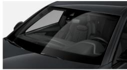
Die zusätzliche Reflexionsbeschichtung vermindert ein Aufheizen des Innenraums bei starker Sonneneinstrahlung und reduziert den Energieverbrauch der Klimaanlage.
