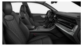
Die aktive Sitzbelüftung reguliert die Belüftung von Fahrer- und Beifahrersitz. Zur Belüftung wird Luft mittels Lüfter durch das perforierte Leder der Sitz- und Lehnenmittelbahn angesaugt. Die Stärke des Luftstroms ist in drei Stufen am Klimabedienteil einstellbar. Der Unterkühlschutz wird durch automatische Beheizung erreicht.
