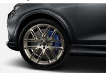
21-Zoll-Hochleistungsbremsanlage mit kohlefaserverstärkten Keramikbremsscheiben vorn und hinten, speziell entwickelten Kühlkanälen in den innenbelüfteten und gelochten Bremsscheiben; Bremssättel in Blau glänzend, mit Schriftzug "Audi ceramic" vorn und hinten
