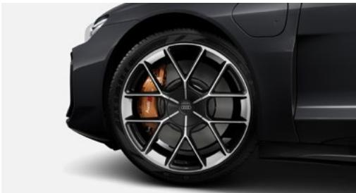
Die 20-Zoll-Hochleistungsbremsanlage mit Bremsscheiben mit Wolframcarbid-Beschichtung vorn und hinten zeichnet sich durch verbessertes Ansprechverhalten aus. Schwarz glänzend lackierte Bremssättel mit dem Schriftzug „Audi carbid“ verleihen eine sportliche Optik.
