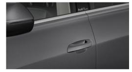
Die Zuziehhilfe sorgt für geräuscharmes und zuverlässiges Schließen der Fahrzeugtüren. Es genügt, die Türen leicht ins Schloss fallen zu lassen: Die Zuziehhilfe zieht nicht vollständig eingerastete Türen automatisch ins Schloss.
