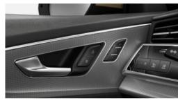
Für Fahrer- und Beifahrersitz steht eine Vielzahl elektrischer Einstellmöglichkeiten zur Verfügung. Die Einstellungen werden für den Fahrersitz gespeichert und zusätzlich automatisch in persönlichen Profilen gesichert.
