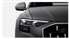
Die Audi Matrix LED-Technologie ermöglicht eine präzise und hoch aufgelöste Ausleuchtung der Straße. Blendeffekte für entgegenkommende bzw. vorausfahrende Fahrzeuge können deutlich reduziert werden.
