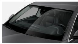
Die Wärmeschutzverglasung aus Verbundsicherheitsglas reflektiert UV-Strahlung und kann damit das Aufheizen des Fahrzeuginnenraums reduzieren.
