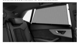
Sonnenschutzrollo, elektrisch für die hinteren Seitenscheiben, manuell für die Heckscheibe
