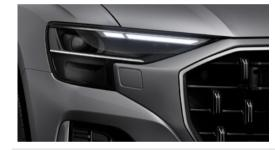
Die Scheinwerfer-Reinigungsanlage sorgt durch eine Reinigung des Scheinwerfers mit Wasser und Hochdruck für mehr Licht auf der Straße.
