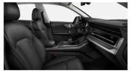
Die aktive Sitzbelüftung reguliert die Belüftung von Fahrer- und Beifahrersitz. Zur Belüftung wird Luft mittels Lüfter durch das perforierte Leder der Sitz- und Lehnenmittelbahn angesaugt. Die Stärke des Luftstroms ist in drei Stufen am Klimabedienteil einstellbar. Der Unterkühlschutz wird durch automatische Beheizung erreicht.
