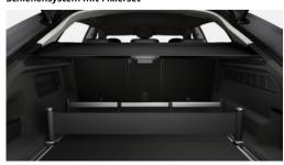
Schienensystem im Gepäckraum, mit Teleskopstange, Fixiergurt und variablen Verzurrösen zur individuellen Aufteilung des
