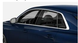
Durch die Doppelverglasung der Tür- und Seitenscheiben wird die Außengeräuschdämmung nochmals deutlich verbessert.
