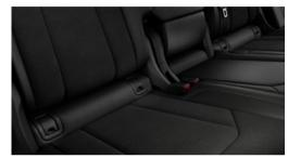
Normhalterung zur praktischen Befestigung von i-Size- und ISOFIX-konformen Kindersitzen auf den äußeren Fondsitzen Mit dem sogenannten Top Tether steht ein zusätzlicher Befestigungspunkt oben an der Rücksitzbank zur Verfügung. Das bewährte ISOFIX-konforme System verbindet einfache Handhabung mit einem Schutz für Kinder im Fahrzeug.
