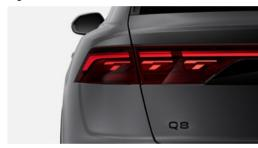
Die digitale OLED-Technologie der Heckleuchten ermöglicht ein faszinierendes Lichtdesign, das beeindruckt. Es ist zudem ein markantes Designelement, betont durch eine sehr homogene und kontrastreiche Ausleuchtung. Die Flächenlichtquelle benötigt keine zusätzlichen Reflektoren, Lichtleiter oder Optiken. Dadurch sind OLEDs effizient und leicht.
