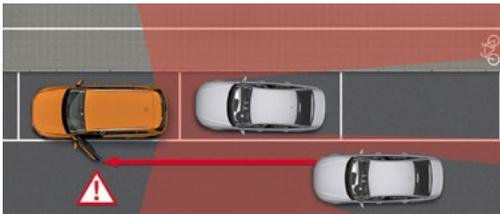
Rücksicht beim Aussteigen. Werden bei einem stehenden Fahrzeug die Türen geöffnet, warnt die Ausstiegswarnung vor möglichen Kollisionen mit erkannten Verkehrsteilnehmenden wie z. B. Fahrzeugen, die sich von hinten nähern. Wenn eine als kritisch eingestufte Situation erkannt wird, leuchten bereits beim Betätigen des Türöffners die Warnleiste in der Tür und die LED-Anzeige am Außenspiegel auf der jeweiligen Fahrzeugseite auf.
