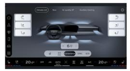
Elektronisch geregelte 3-Zonen-Komfortklimaautomatik für individuell auf Fahrer- und Beifahrerseite sowie den hinteren Fahrzeuginnenraum abgestimmte Klimatisierung. Die gewünschte Temperatur und Luftverteilung können für jeden der drei Bereiche separat eingestellt werden.
