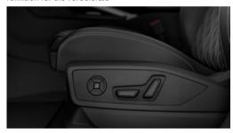
Die Lendenwirbelstütze sorgt durch gezieltes Be- und Entlüften der Lordose-Blasen in den Vordersitzen für Unterstützung im Lendenwirbelbereich und ist über eine Lendenwirbelstützentaste am Sitz einstellbar.
