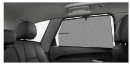
Das Sonnenschutzrollo ist manuell aus- und einfahrbar. Zur Fixierung kann es am Fensterrahmen oben eingehängt werden. Dadurch wird der Fahrzeuginnenraum im Fond bei Sonneneinstrahlung verdunkelt und vor neugierigen Blicken von außen verdeckt. Bei Nichtgebrauch kann das Sonnenschutzrollo im Fensterschacht vollständig versenkt werden.
