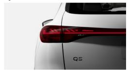
Die zweite Generation der innovativen digitalen OLED-Technologie der Heckleuchten ermöglicht ein neues Level neuartigen Lichtdesigns und erreicht eine beeindruckende Homogenität sowie scharfe Kontraste in der Ausleuchtung.
