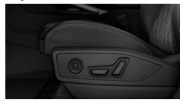
Elektrisch, horizontal und vertikal in vier Richtungen individuell einstellbar, sorgt die Lendenwirbelstütze für eine entspannte, ergonomische Sitzhaltung.
