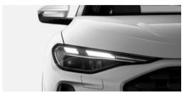
Die LED-Scheinwerfer erzeugen eine tageslichtähnliche Ausleuchtung der Fahrbahn und überzeugen durch einen geringen Energieverbrauch, eine hohe Lebensdauer und eine gute Sichtbarkeit für andere.
