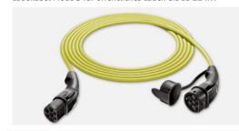
Ladekabel zum Laden an öffentlichen AC-Ladesäulen mit Typ-2-Stecker. Das 6 m lange Kabel verbindet die Ladesäule mit dem AC-Ladezugang des Fahrzeugs. Das Ladekabel unterstützt eine Ladeleistung von bis zu 22 kW (dreiphasig). Dabei kann pro Phase eine Stromstärke von bis zu 32 A übertragen werden.
