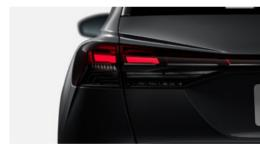
Heckleuchten in LED-Technologie überzeugen gegenüber Heckleuchten mit Glühlampen durch eine schnellere Aktivierung des Schluss- und Bremslichts, wodurch eine frühere Wahrnehmung durch den nachfolgenden Verkehr ermöglicht wird.
