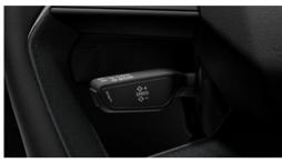
Der einstellbare Geschwindigkeitsbegrenzer hilft ab ca. 20 km/h z. B. innerhalb geschlossener Ortschaften, eine vorher eingestellte Maximalgeschwindigkeit nicht zu überschreiten. Beim Erreichen des eingestellten Limits regelt das Fahrzeug sanft ah
