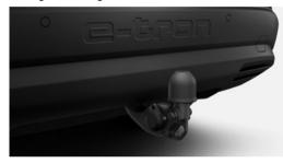
Die mechanisch schwenkbare Anhängevorrichtung lässt sich komfortabel über eine Auslösevorrichtung elektrisch entbzw. verriegeln.
