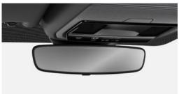
Das Spiegelglas kann manuell über einen Kipphebel am Spiegel abgeblendet werden.
