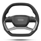
Das oben und unten abgeflachte Doppelspeichen-Sportlederlenkrad überzeugt durch seine sportliche Optik und liegt gut in der Hand. Höhe und Abstand des Lenkrads sind manuell einstellbar. Zur komfortablen Bedienung der umfangreichen serienmäßigen und optionalen Infotainment-Umfänge ist das Lenkrad mit Multifunktionstasten mit Touchbedienung ausgestattet. Schaltwippen ermöglichen das manuelle Wechseln der Fahrstufen.
