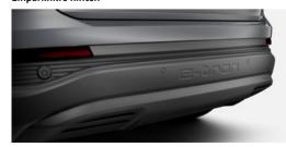
Die Einparkhilfe hinten unterstützt das rückwärtige Parken und Rangieren innerhalb der Systemgrenzen durch akustisches und optisches Anzeigen des Abstands hinter dem Fahrzeug. Die Messung erfolgt durch unauffällig in den Stoßfänger integrierte Ultraschallsensoren, die bei eingelegtem Rückwärtsgang aktiviert werden. Eine selektive, optische Anzeige stellt den Abstand zu erkannten Objekten nach hinten dar.
