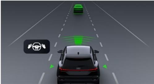
Der adaptive Fahrassistent plus unterstützt beim Beschleunigen, Bremsen, Halten von Geschwindigkeit und eingestelltem Abstand sowie bei der Spurführung. Dadurch kann der Fahrkomfort speziell auf Langstrecken gesteigert werden.
