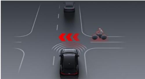
Der Querverkehrassistent vorn ist Bestandteil des Aktiven Frontassistenten und überwacht mithilfe der in der Fahrzeugfront verbauten Radarsensoren das vordere und seitliche Fahrzeugumfeld im Bereich von Kreuzungen und Ausfahrten.
