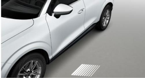
Die Projektionsleuchte an der Unterseite der Außenspiegel projiziert ein grafisches Element auf den Untergrund. Dies sorgt nicht nur für eine Verbesserung der Ausleuchtung im Einstiegsbereich des Fahrzeugs beim Ein- und Aussteigen, sondern auch für einen ausdrucksstarken Blickfang.
