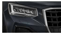
Die Scheinwerfer-Reinigungsanlage sorgt für mehr Licht auf der Straße, besonders bei ungünstigen Witterungsverhältnissen. Durch eine Reinigung mit Wasser und Hochdruck wird eine bessere Leuchtkraft und eine gute Sicht durch geringe Streuung erzeugt.
