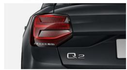
Die Lichtsignatur ist ein sichtbares Erkennungszeichen nach hinten. Ein entscheidender Vorteil der Bremsleuchten in LED-Technologie ist die schnellere Aktivierung zur Warnung anderer Verkehrsteilnehmer.
