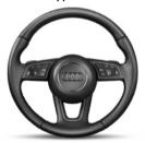
mit Fullsize-Airbag, in Höhe und Abstand einstellbar, inklusive Wählhebelknauf in Leder; mit 12 Multifunktionstasten zur komfortablen Bedienung der vorhandenen Infotainment-Umfänge, wie z.B. Medien, Telefon, Navigations- oder der frei programmierbaren Taste; Schaltwippen zum manuellen Wechseln der Fahrstufen
