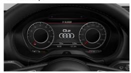
Mit dem Audi virtual cockpit steht ein innovatives, volldigitales Kombiinstrument zur flexiblen und bedarfsgerechten Anzeige von Informationen zur Verfügung. Das 12,3-Zoll-Display hat eine hohe Auflösung. Angezeigt werden können entsprechend den Fahrerbedürfnissen Geschwindigkeit, Drehzahl, Kartendarstellung, Audi connect-Dienste<sup>4</sup>, Radio- und Media-Informationen und vieles mehr.
