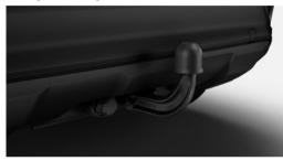
Die abnehmbare Anhängevorrichtung steht bei Bedarf schnell zur Verfügung. Sie ist abschließbar und ist mit Kugelstange und -kopf aus geschmiedetem Stahl ausgestattet. Die 13-polige Steckdose kann unsichtbar hinter die Stoßfängerschürze geschwenkt werden. Inkl. Gespannstabilisierung über die elektronische Stabilisierungskontrolle ESC.
