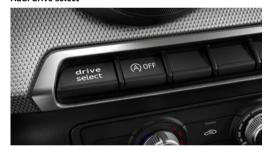
Audi drive select ermöglicht die Einstellung der gewünschten Fahrzeugcharakteristik in verschiedenen verfügbaren Modi über ein separates Bedienelement in der Schalterleiste der Mittelkonsole und über das Bediensystem MMI. Dabei erfolgt die Anpassung der Lenkunterstützung, der Motorcharakteristik bzw. der Schaltkennlinie (bei Fahrzeugen mit S tronic) sowie weiterer serienmäßiger und optionaler Systeme.
