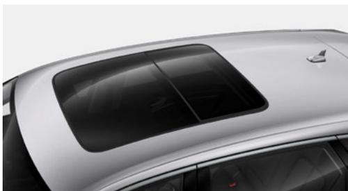
Das Panorama-Glasdach überzeugt durch eine komfortable Bedienung. Ausstellen und Öffnen des Glaselements erfolgen elektrisch. Ebenso komfortabel werden die lichtdichten Sonnenrollos betätigt. Von außen kann mit dem Funkschlüssel mittels Komfortöffnung und -schließung das Panorama-Glasdach mitbedient werden.
