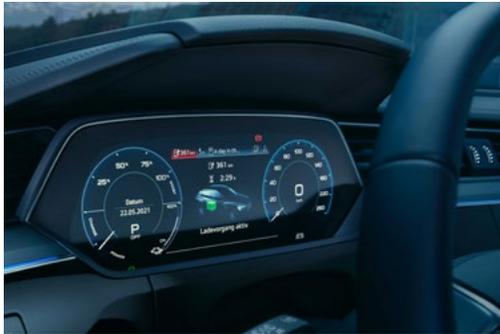
Mit dem Audi virtual cockpit steht ein innovatives, volldigitales Kombiinstrument zur flexiblen und bedarfsgerechten Anzeige von Informationen zur Verfügung. Das 12,3-Zoll-Display hat eine Auflösung in Full-HD-Qualität. Angezeigt werden können entsprechend den Bedürfnissen der fahrenden Person Geschwindigkeit, Leistungsabruf, Kartendarstellung, Audi connect-Dienste<sup>16</sup>, Radio- und Media-Informationen und vieles mehr.
