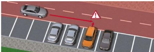
Der **Querverkehrsassistent hinten<sup>7, 41</sup>** kann beim Rückwärtsfahren bis 10 km/h (z. B. beim Ausparken) vor einer möglichen Kollision mit herannahenden, bewegten Objekten (wie z. B. Autos im Querverkehr) warnen. Mithilfe der Radarsensoren wird beim Ausparken das rückwärtige und seitliche Fahrzeugumfeld überwacht.
