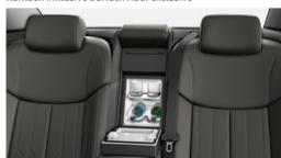
Das Ablagefach der Kühlbox Audi exclusive bietet Platz für zwei liegende 1-Liter-Flaschen. Ein zusätzliches Ablagefach beinhaltet zwei Gläser mit Audi exclusive-Schriftzug. Die Kühlbox ist mit einer Innenbeleuchtung in LED-Technologie ausgestattet und wird mit Kompressor-Kühltechnik betrieben. Die Temperatur kann zwischen –6 °C und +6 °C eingestellt werden.
