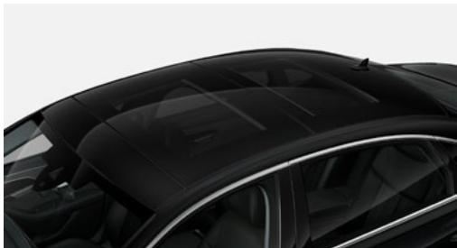
Das zweiteilige Panorama-Schiebedach überzeugt durch eine komfortable Bedienung. Ausstellen und Öffnen des Glaselements erfolgen elektrisch. Ebenso komfortabel werden die lichtdichten Sonnenrollos betätigt. Von außen kann mit dem Funkschlüssel mittels Komfortöffnung und -schließung das Panorama-Schiebedach mitbedient werden. Der integrierte Windabweiser reduziert Windgeräusche bei geöffnetem Dach.
