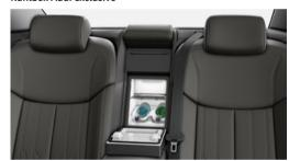
Das Ablagefach der Kühlbox Audi exclusive bietet Platz für zwei liegende 1-Liter-Flaschen. In einem zusätzlichen Ablagefach können Dosen und Gläser verstaut werden. Die Kühlbox ist mit einer Innenbeleuchtung in LED-Technologie ausgestattet und wird mit Kompressor-Kühltechnik betrieben. Die Temperatur kann zwischen –6°C und +6°C eingestellt werden.
