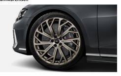
Die Hochleistungsbremsanlage mit kohlefaserverstärkten Keramikbremsscheiben zeichnet sich durch hervorragende Verzögerungswerte aus. Die Keramikbremsscheiben sind innenbelüftet und gelocht. Für eine verbesserte Wärmeabfuhr beim Bremsen wurden spezielle Kühlkanäle für die Bremsscheibe entwickelt. An der Vorderachse kommen 20-Zoll-Keramikbremsscheiben und an der Hinterachse 19-Zoll-Keramikbremsscheiben zum Einsatz.
