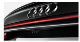
Die Rückfahrkamera stellt im oberen MMI touch response-Display den Erfassungsbereich hinter dem Fahrzeug dar. Dynamische Anzeigeelemente wie eine berechnete Fahrspur unterstützen beim Einparken oder Rangieren.
