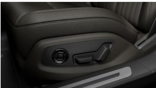
Für Fahrer- und Beifahrersitz steht eine Vielzahl elektrischer Einstellmöglichkeiten zur Verfügung:
