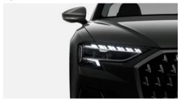
Die Scheinwerfer-Technologie der digitalen Matrix LED-Scheinwerfer ermöglicht es, hoch aufgelöste Lichtbilder bzw. -animationen direkt vor dem Fahrzeug zu projizieren. Ergänzt wird diese Innovation durch zahlreiche Möglichkeiten der adaptiven Lichtverteilung und der Lichtassistenz. Das dynamische Blinklicht der Matrix LED-Scheinwerfer läuft beim Blinken immer zur Außenseite in Abbiegerichtung und ist dadurch gut wahrnehmbar.
