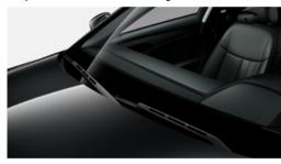
Das adaptive Scheibenwischersystem ermöglicht durch gründliche Reinigung bei gleichzeitig geringem Waschwasserverbrauch eine gute Sicht bei jedem Wetter. Die Reinigungsflüssigkeit wird direkt vor die Wischerblätter gesprüht und nahezu ohne Verzögerung weggewischt, sodass auch während des Wischvorgangs die Sicht weitestgehend frei bleibt. Dadurch wird das Trockenwischen reduziert und somit die Langlebigkeit der Wischerblätter erhöht.
