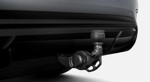
Die Anhängevorrichtung mit mechanisch schwenkbarem Kugelkopf lässt sich komfortabel über eine Taste im Gepäckraum elektrisch entriegeln.
