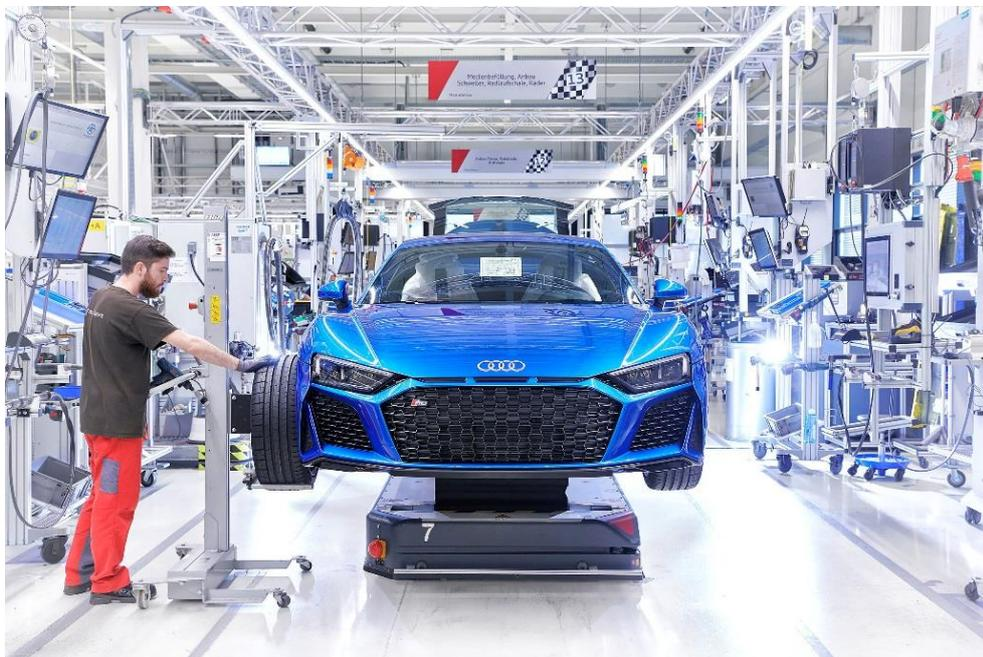
Die fertige Karosserie wird von einem selbstfahrenden Montage-Skid, dem so genannten fahrerlosen Transportsystem (FTS), in die Montage gebracht. Das FTS nutzt Hochleistungskondensatoren als Energiespeicher und orientiert sich per
