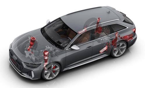
Die serienmäßige Luftfederung RS-adaptive air suspension mit geregelter Dämpfung wurde RS-spezifisch abgestimmt und lässt den RS 6 Avant\* und RS 6 Avant performance\* dank eines Luftfedermoduls mit einer um 50 Prozent höheren Federrate erstmals bis zu 305 km/h schnell werden (mit Dynamikpaket plus). Sie lässt sich in mehreren Modi einstellen und integriert einen automatischen Niveauausgleich.
